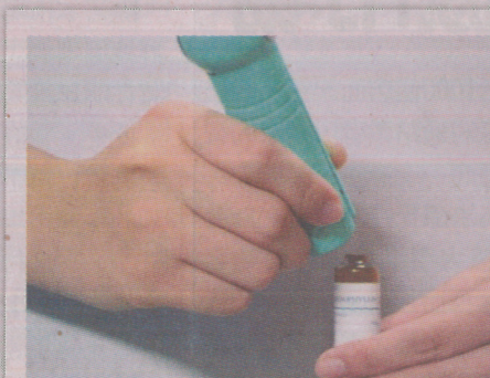
●慈濟科技大學的安瓿折斷器，利用套入、折斷、鬆放三個動作，即可安全開啓各種安瓿容量。 圖／慈濟科技大學提供
